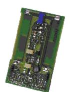
Mit den Elektronik-Varianten wird das **CSM8.055** zu universellen autarken Stromversorgungskomponenten erweitert, die sich insbesondere zur Integration in mobile oder an hellen Standorten montierte elektrische Kleingeräte eignen, z. B. Mess-, Audio-, Funkmodule, Sensoren und Organizer.
